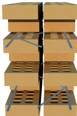
Muro doblado (con sutura continua)
