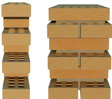
Muros de una hoja (con sutura discontinua)
