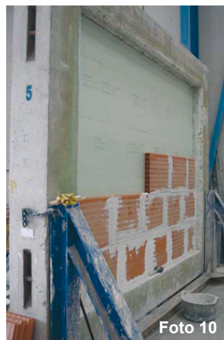
Fotos 9 y 10: Montaje de fábrica de ladrillo gran formato
